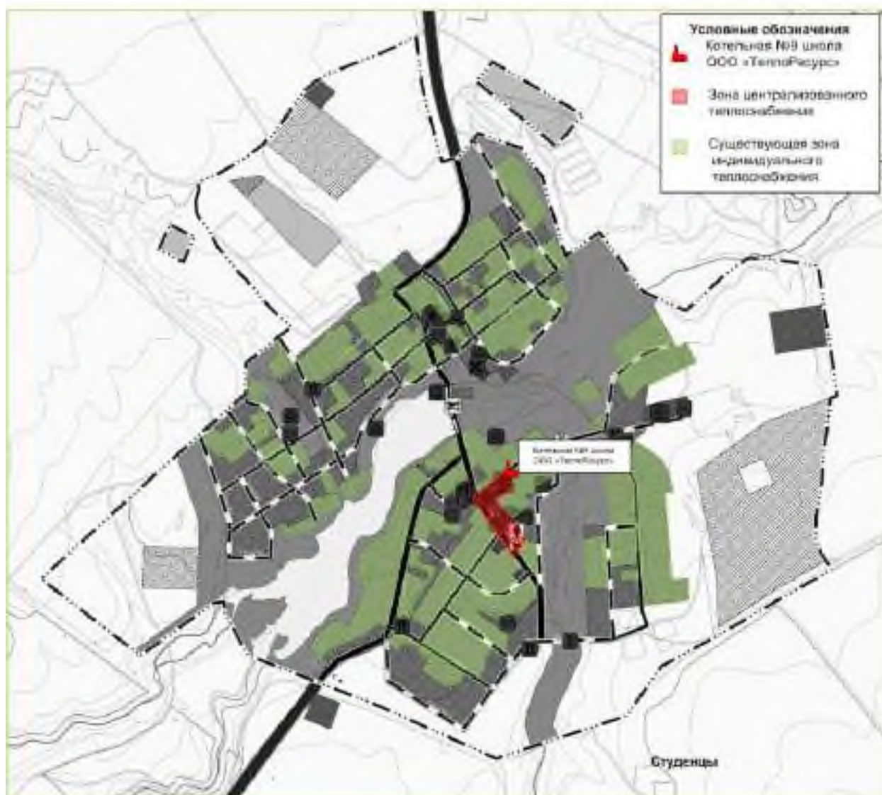
Рисунок 1.1.1.1 – Зоны действия централизованной котельной ООО «ТеплоРесурс», а также индивидуальных источников тепловой энергии, находящихся в частной собственности жителей с. Студенцы
